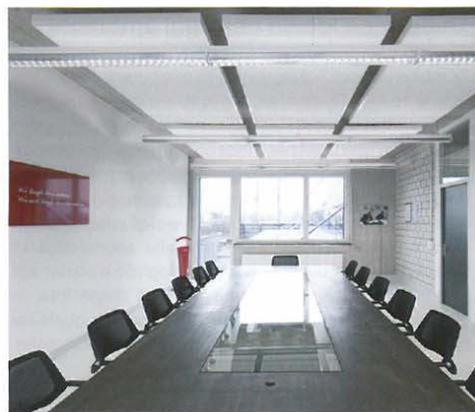
Il controsoffitto **Techstyle Islands** di **Hunter Douglas** si compone di pannelli in fibra di vetro a struttura alveolare pre-assemblati a un telaio realizzato con profili di alluminio. Si caratterizza per le elevate prestazioni di fonoassorbenza e la facile installazione e maneggevolezza grazie al peso ridotto (1.3kg/mq)
