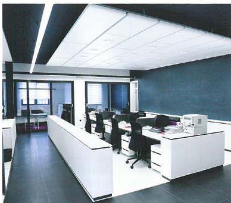
**Ecophon Master Matrix** è un sistema di controsoffitti acustici, pensato per aree di grandi dimensioni dove è richiesta una grossa copertura di superficie del soffitto ma non è possibile realizzare un controsoffitto continuo. Il sistema, costituito da pannelli in lana di vetro ad alta densità realizzati con la nuova tecnologia 3RD. I pannelli sono dotati di funzione di apertura, e possono essere smontati con facilità
