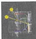
Il sistema di facciata permette di utilizzare gli apporti solari per riscaldare gli ambienti quando necessario ed evitare i surriscaldamenti attraverso la ventilazione.
