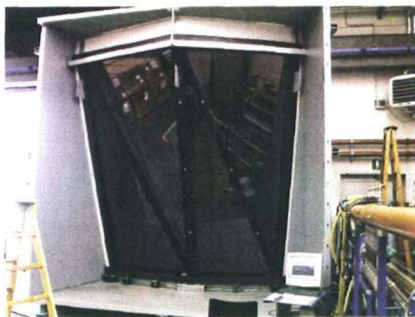
Immagine 9. Moduli del sistema di involucro. I componenti di facciata, intelaiati dai profili in alluminio, in forma angolata o dotati delle sedi per le guarnizioni cingivetro angolari necessarie alla configurazione inclinata, sono prodotti per definire la formazione spezzata al piano di prospetto
